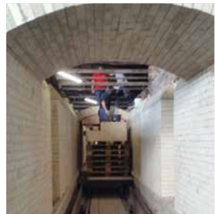
Tunnelofen der Firma Rath zum Brennen von Feuerleichtsteinen
