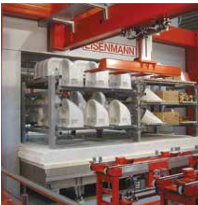
Tunnelofen für Sanitärbereich und Klinkerbrand
