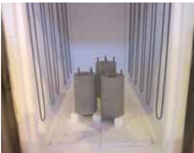
HT-Ofen bis 1700 °C mit ACS-Bauteilen in Decke und Wand
