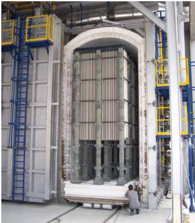
Herdwagenofen zum Brennen von Keramikrohren Höhe: 8 m, Breite: 4 m, Temperatur: 1650 °C
