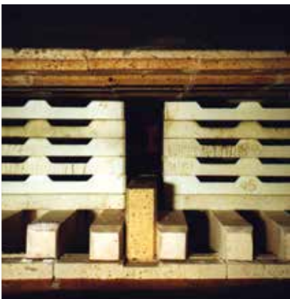
Schubplattenofen zum Brennen von Ferriten
