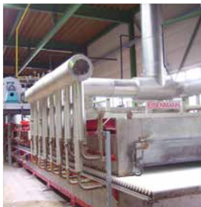
Rollenofen zum Glühen von Aluminiumoxidmatten
