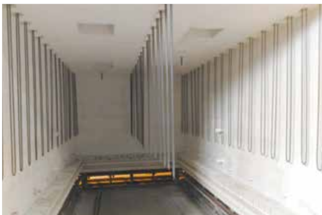
Elektrisch beheizter Herdwagenofen mit Zustellung von Ultra-Modulen für Einsatztemperatur von 1600 °C
