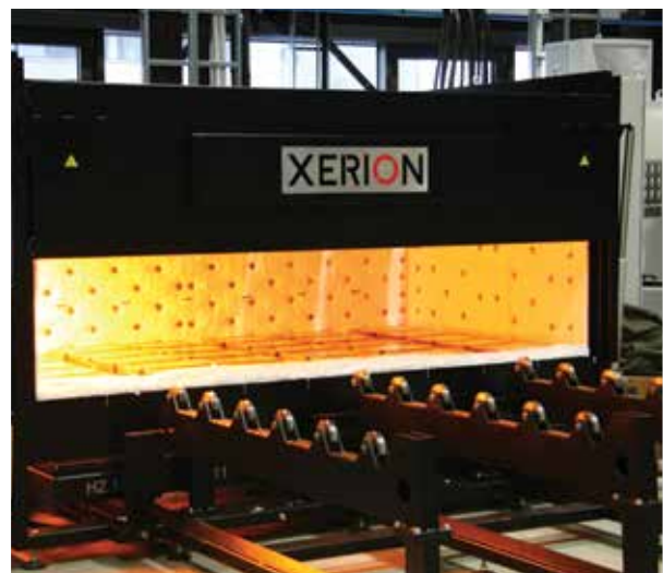
Infrarotofen zum Aufschäumen von Aluminiumplatten
