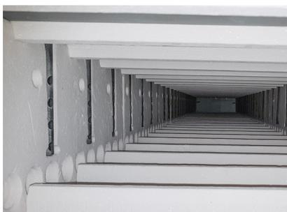
Blick in den Ofen in Durchlauf-richtung, mit Einblasungen und Absaugungen links und rechts.
