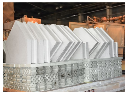
Bauteile auf einem Tunnelofenwagen nach dem Brennen
